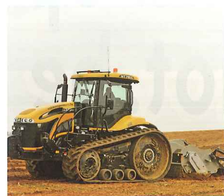
De grondvoorbereiding met de frees die ook bomen kan rooien.
