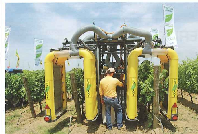
De Caffini driftstopper wordt aan de Belgische fruitteelt aangepast.
